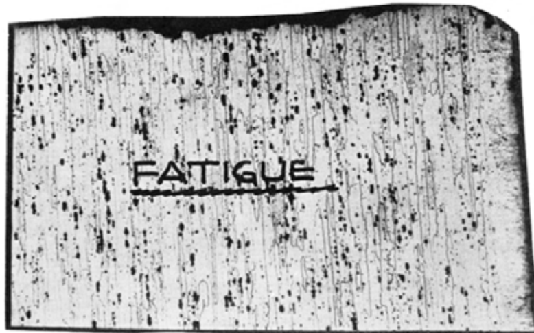
Figure 6A-26 Photomicrograph of fracture clad aluminum alloy Photomicrographie d'une fracture d'un alliage d'aluminium de revêtement
