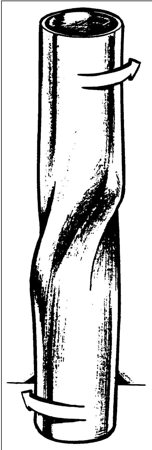
Figure 6A-23 Torsion failure of thin-walled tube due to buckling Rupture en torsion d'un tuyau à paroi mince causée par le flambage
