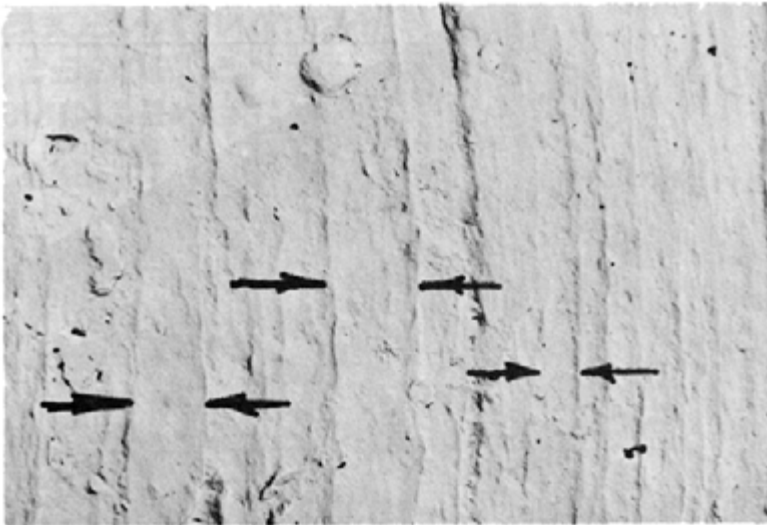
Microscopic growth steps within fatigue zone Étape de croissance microscopique dans la zone de fatigue
